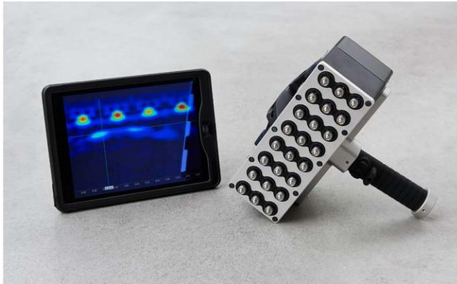
Pundit Live Array Pro 以无线方式连接到 iPad
